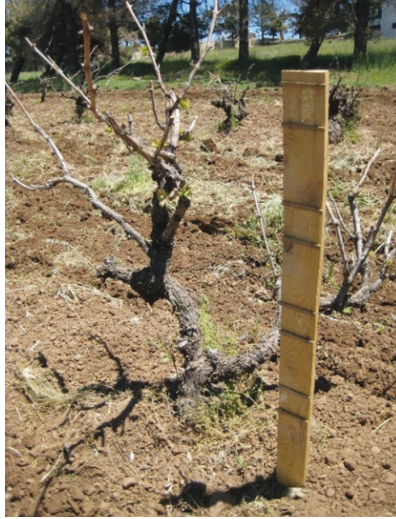
الشكل 1. مصيدة أبواغ خشبية (125 x 10 x 2.5 سم) توضع فيها الشرايح الزجاجية المطلية بالفازلين على أربعة ارتفاعات (25، 50، 75 و100 سم) عن سطح الأرض.
