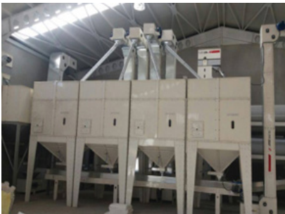
الشكل (11) الغرابيل المخصصة لتنظيف بذار القمح وتدرجها.
