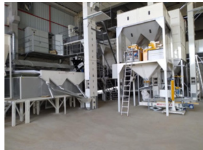
الشكل (11) الغرابيل المخصصة لتنظيف بذار القمح وتدرجها.
