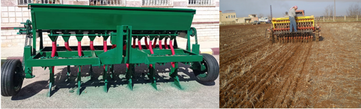
الصورة 3. آلات الزراعة الحافظة المستوردة (اليمن)، والمصنعة محلياً (اليسار).
