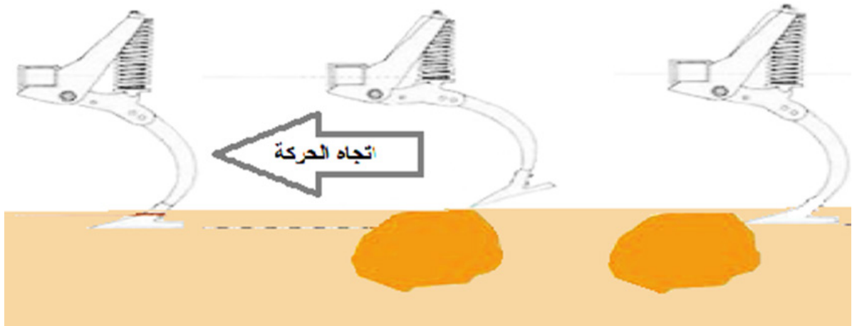
الشكل 17. نظام الحماية الميكانيكي (النابضي).
