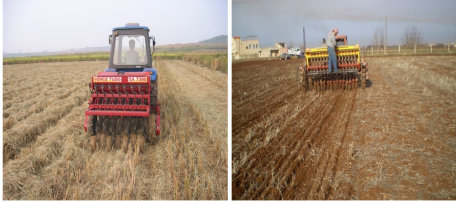
الصورة 2. الآلات المستعملة في زراعة الأرض بشكلٍ مباشر (بدون فلاحه)، والتسميد بعملية زراعية واحدة.
