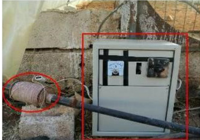
الشكل 2. جهاز المغنطة الكهربائي المستخدم في الدراسة.
