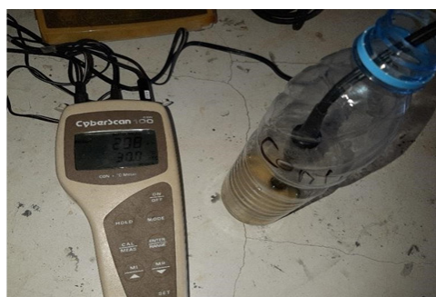
جهاز تقدير الناقلية الكهربائية (EC) للتربة
