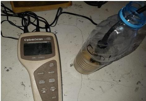
جهاز تقدير الناقلية الكهربائية (EC) للتربة
