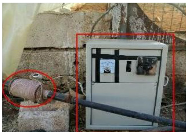
الشكل 2. جهاز المغنطة الكهربائي المستخدم في الدراسة.
