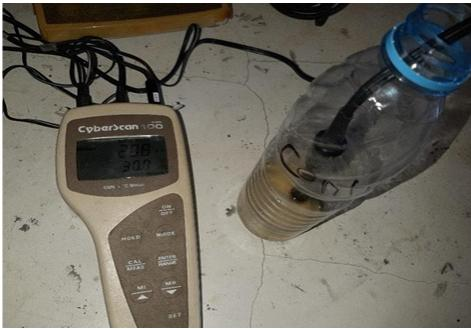
جهاز تقدير الناقلية الكهربائية (EC) للتربة
