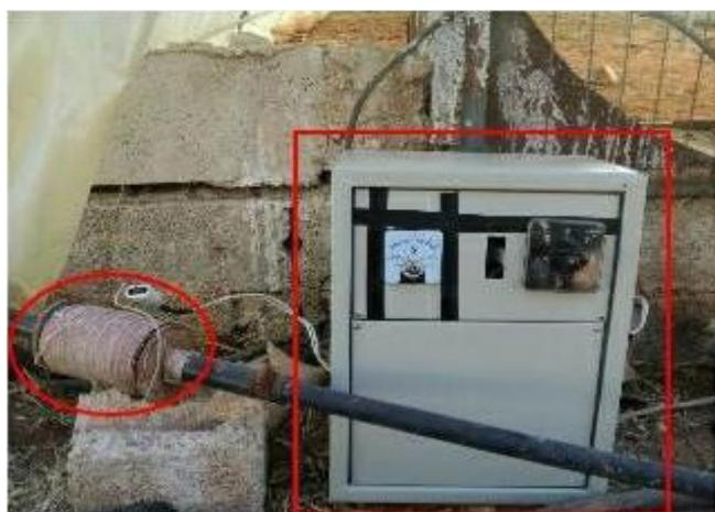
الشكل 2. جهاز المغنطة الكهربائي المستخدم في الدراسة.
